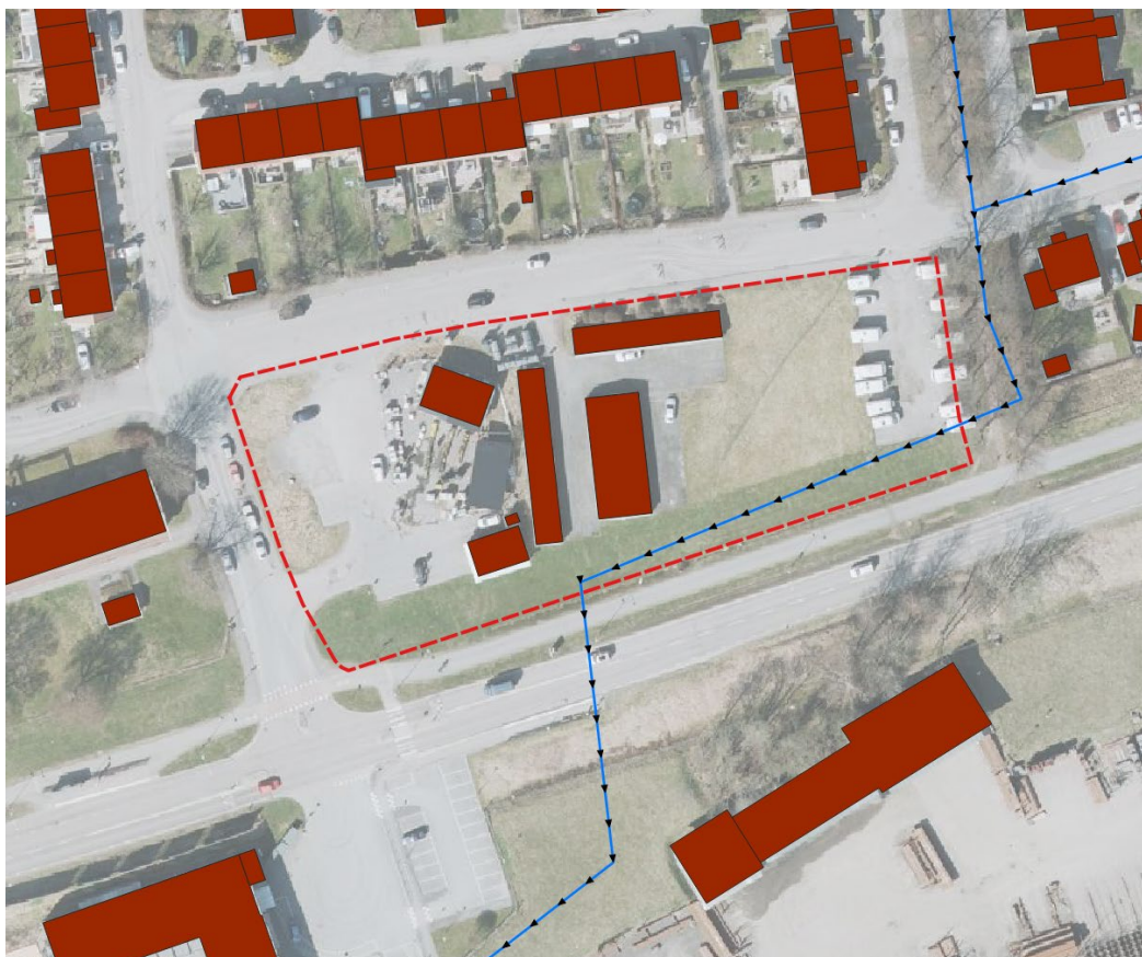
Figur 14. Rödmarkering är detaljplaneområdet. Blått sträck är förslag till skyfallsled placering. Pilar visar skyfallsleds riktningen. (Kretslopp och vatten).
