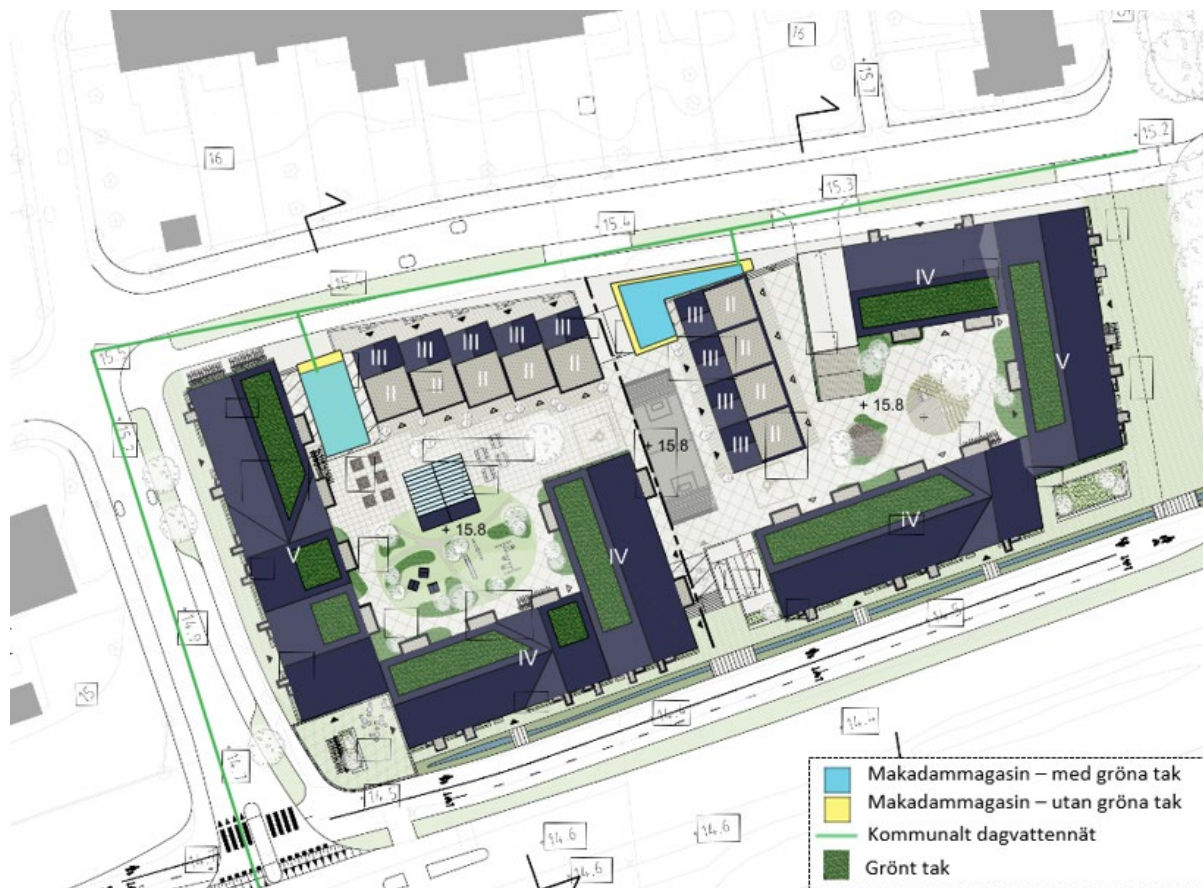
Figur 34. Illustration av placering för föreslagen dagvattenlösning. Marknivåer på innergård är föreslagna marknivå.
